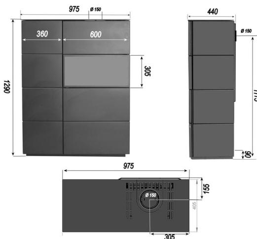
Die in dieser Anleitung beschriebenen Kaminöfen der Bauart 1 sind nach DIN EN 13240 geprüft. Kaminöfen dieser Bauart dürfen an mehrfach belegte Schornsteine angeschlossen werden, sofern die Dimension des Schornsteins dieses zulässt. Die DIN 4705, Teil 3 ist zu beachten.
