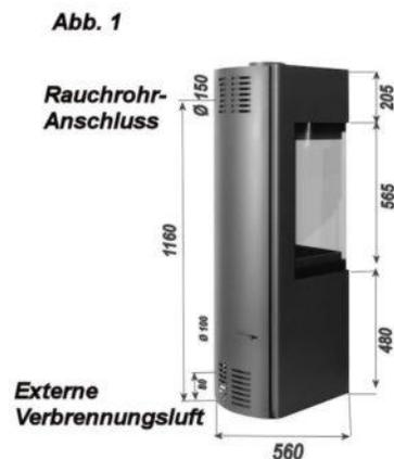
Die in dieser Anleitung beschriebenen Kaminöfen der Bauart 1 sind nach DIN EN 13240 geprüft. Kaminöfen dieser Bauart dürfen an mehrfach belegte Schornsteine angeschlossen werden, sofern die Dimension des Schornsteins dieses zulässt. Die DIN 4705, Teil 3 ist zu beachten.
