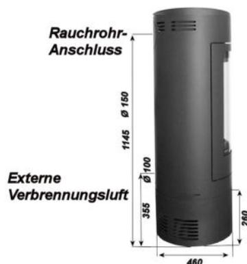
Die in dieser Anleitung beschriebenen Kaminöfen der Bauart 1 sind nach DIN EN 13240 geprüft. Kaminöfen dieser Bauart dürfen an mehrfach belegte Schornsteine angeschlossen werden, sofern die Dimension des Schornsteins dieses zulässt. Die DIN 4705, Teil 3 ist zu beachten.
