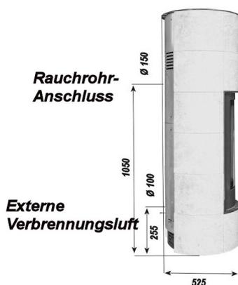
Die in dieser Anleitung beschriebenen Kaminöfen der Bauart 1 sind nach DIN EN 13240 geprüft. Kaminöfen dieser Bauart dürfen an mehrfach belegte Schornsteine angeschlossen werden, sofern die Dimension des Schornsteins dieses zulässt. Die DIN 4705, Teil 3 ist zu beachten.
